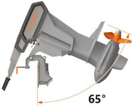
Abb. 24: Motor vollständig hochgekippt
